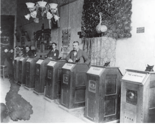
चित्र-3: सैन फ्रैंसिस्को में एक किनेटोस्कोप पार्लर (1894-95)। इन किनेटोस्कोप के ऊपरी भाग के पीपिंग होल (झाँकने के लिए छिद्र) से आँख लगाकर चलचित्र देखे जाते थे। इसके अन्दर एक प्रकाश स्रोत के ऊपर एक फिल्म की पट्टी घूमती रहती थी। उसी के ऊपर कई चीरों वाला एक पहिया भी घूमता रहता था जो एक शटर का काम करता था, जिससे देखने वाले को आभास होता कि वे अलग-अलग तस्वीरें न होकर, एक चलता चित्र है।
