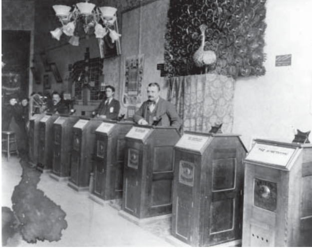
चित्र-3: सैन फ्रैंसिस्को में एक किनेटोस्कोप पार्लर (1894-95)। इन किनेटोस्कोप के ऊपरी भाग के पीपिंग होल (झाँकने के लिए छिद्र) से आँख लगाकर चलचित्र देखे जाते थे। इसके अन्दर एक प्रकाश स्रोत के ऊपर एक फिल्म की पट्टी घूमती रहती थी। उसी के ऊपर कई चीरों वाला एक पहिया भी घूमता रहता था जो एक शटर का काम करता था, जिससे देखने वाले को आभास होता कि वे अलग-अलग तस्वीरें न होकर, एक चलता चित्र है।
