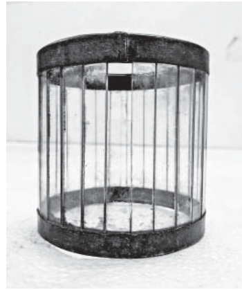
चित्र-1: पेट्रोमेक्स (बाएँ) नाम का एक केरोसीन लैंप, जिसमें स्क्रीन के तौर पर काँच की पट्टियाँ (दाएँ) लगी होती हैं।
